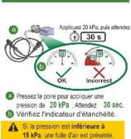
**Réalisation d'un test d'étanchéité « mouillé »**
